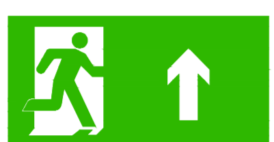
INDICAÇÃO DE UMA SAÍDA DE EMERGENCIA A SER FIXADA ACIMA DA PORTA, PARA INDICAR O SEU ACESSO - 14
